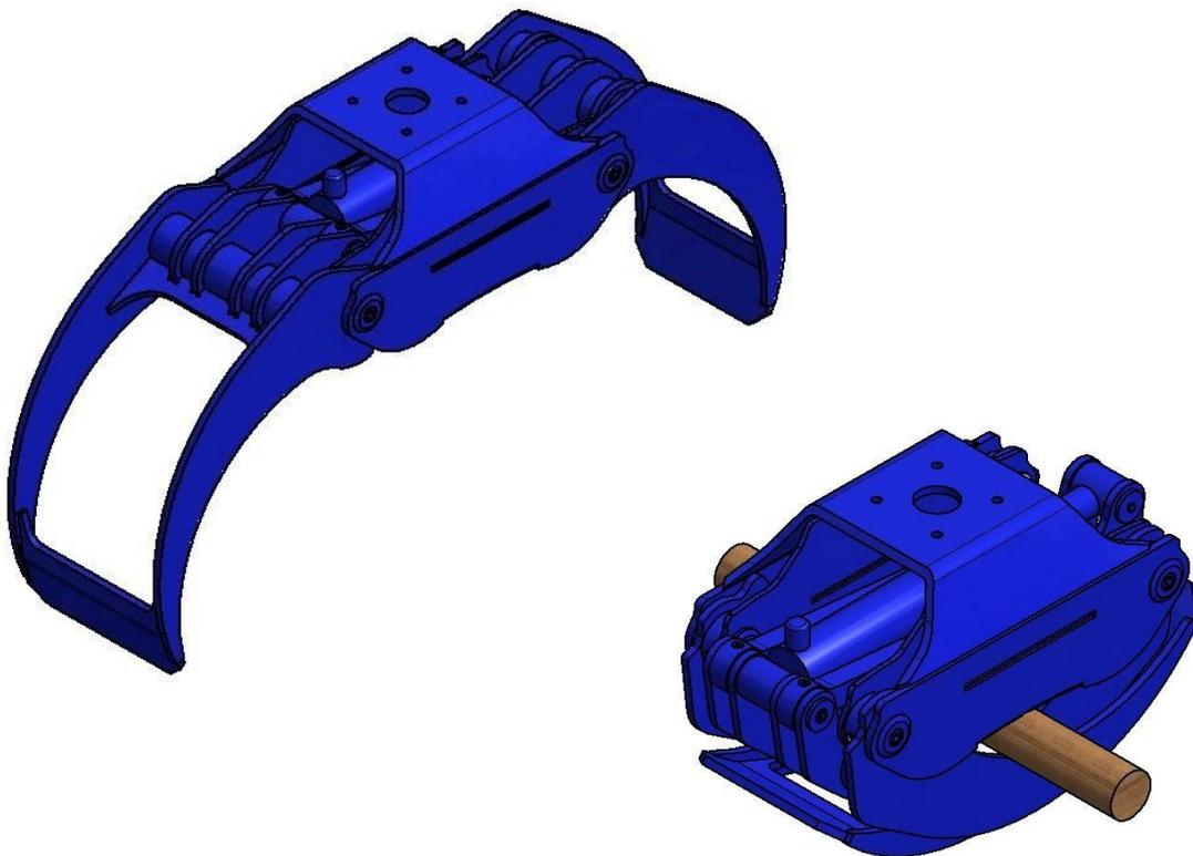
La pinza NBM viene impiegata per la movimentazione di tronchi e materiale legnoso per gru da camion.
