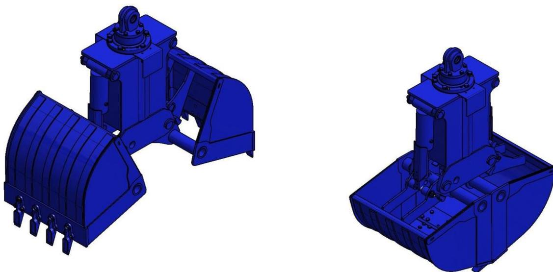
La benna mordente è ideale per effettuare operazioni di scavo e di movimentazione materiali sfusi (ghiaia, fango, calcinacci, sabbia e terra)
